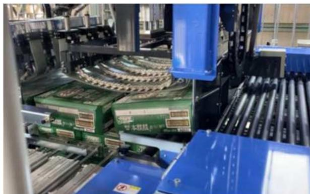
図-4. レイヤー自動ピッキング装置
