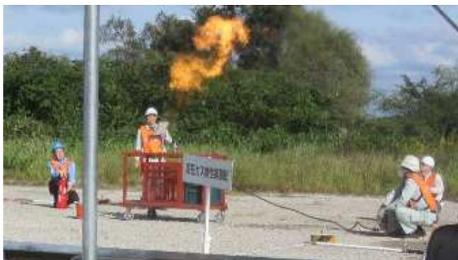
LPガスの気化ガス燃焼/液燃焼の比較実験
