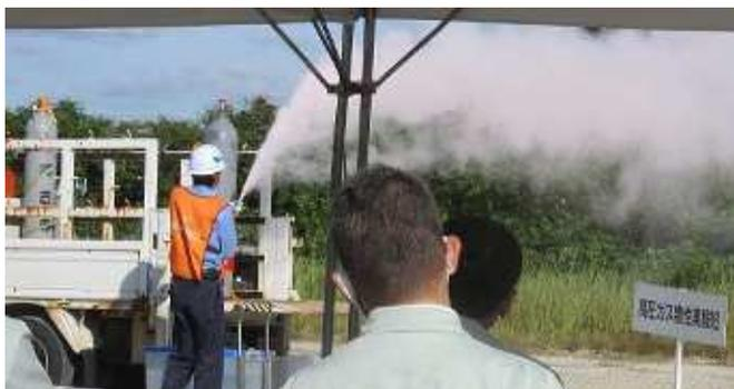
モノシランガスの漏えい/消火訓練(富山県では粉末消火器を使用しています。)
