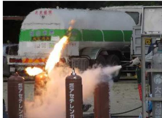
消火訓練：着火延焼したアセチレン容器を消火器で消火します。
