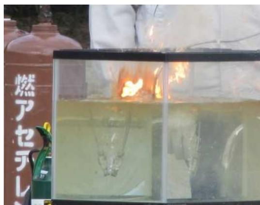
モノシランを水中に放出してみると、気泡が水面に出た瞬間に発火します。
